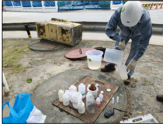
รูปที่ 3.7 การเก็บตัวอย่างคุณภาพน้ำทิ้ง บริเวณ บ่อน้ำทิ้งหลังผ่านระบบบำบัดน้ำเสียของโครงการ (Ww)
