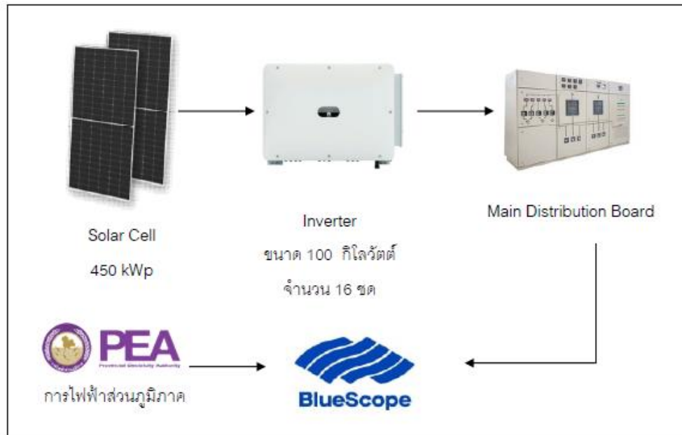
ภาพที่ 1.4 แผนภาพการผลิตไฟฟ้าจากแผงเซลล์แสงอาทิตย์ของโครงการ
